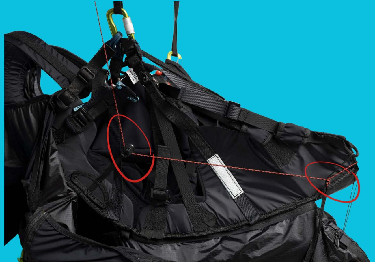
MAKE SURE THE SPEEDBAR ROPE GOES THROUGH THE PULLEYS.
